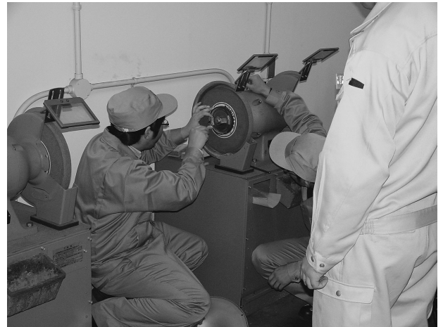
図10 砥石の交換実習
