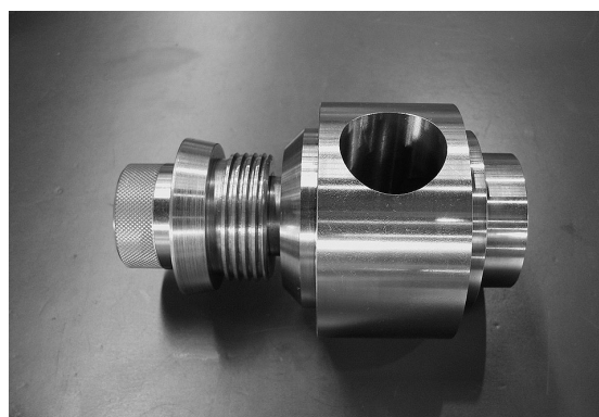
図13 部品①と部品⑥の組み付け偏芯位置が合い、また組み付け寸法も予定どおり仕上げる事ができた
