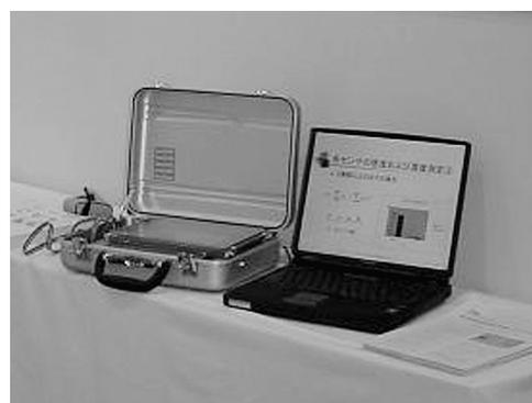
図13 室内空気汚染度評価システム
