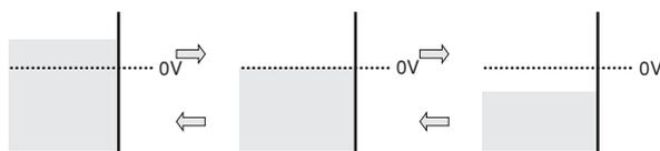
図16 交流電圧源の水モデル
