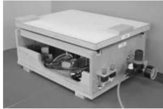
図6 作成した振動台
