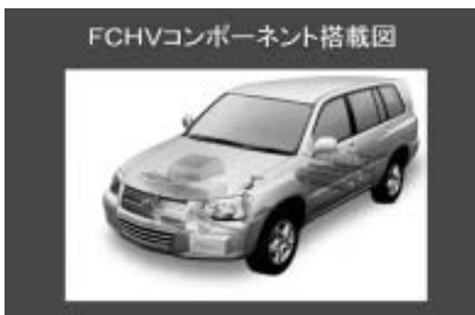
ロールユニットというのは、電気自動車やハイブリッド車と同じものですし、二次電池も基本的に同じと考えてよいでしょう。燃料電池固有の部品のうち高圧水素タンクを、乗用車の場合は床下に配置し、燃料電池の本体であるスタックはエンジンルームに配置するのが一般的です。この配置は高電圧、高圧水素といった危険な部分をユーザがあまり触ることがないところに封じ込めてしまおうという安全性確保の考えによるものです。
