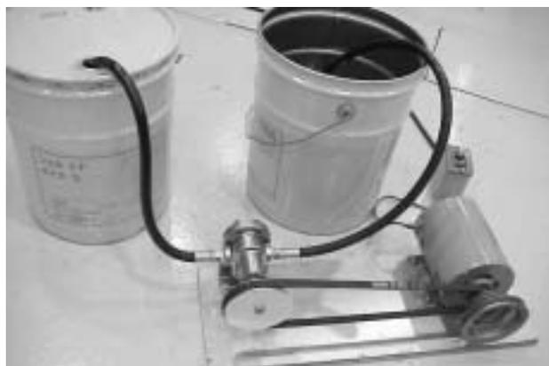
写真2 製作した歯車ポンプの試運転
