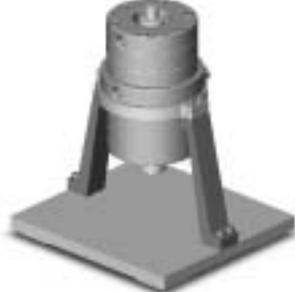
図9 空気静圧スピンドルの3次元モデル
