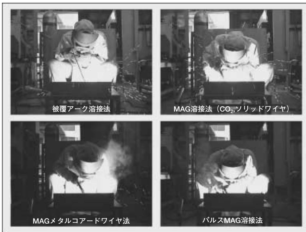
写真3 各種アーク溶接のスパッタ発生量の比較
