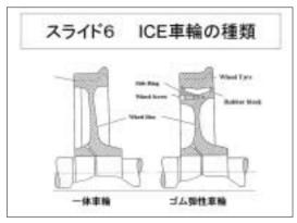
空気ばねを使っていないので振動,騒音が大きく,食堂車が特に揺れるということで,ドイツ鉄道の技術者は,事故の6年前にゴム付き弾性車輪という新型車輪を採用しました。日本やフランスの高速鉄道の車輪のように,普通の車輪は鍛造で作られた,全部が一体となっている一体車輪ですが,ドイツの技術者が考えたのは,ゴム弾性車輪といってゴムを入れた分割型の車輪です。車輪の中心部の円盤状のものを輪心といいますが,その外側にゴム・ブロックを入れて,その外側にタイヤが嵌合されている構造です。タイヤには,曲線路を走行するときに脱線しないようにフランジがあります。
