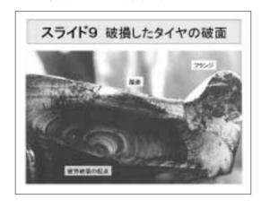
事故原因は車輪タイヤの破壊であったといいまし たが、これがその破断面の写真です。破断面には明 瞭な貝殻模様が見られ, 典型的な疲労破壊の破面で す。疲労破壊というのは、荷重が繰り返されてひず みが繰返されると、そこに小さなき裂ができて、そ のき裂が半円状に進展していくのですから、 貝殻模 様はその進んでいった痕跡です。貝殻模様の外側の フランジには貝殻模様と違って, ボツボツがあるよ うに見えます。これは脆性的に壊れた面で、最後は この部分だけで荷重を支えて走ったわけです。それ で、ある大きな荷重に耐えられずに衝撃的に、一瞬 にここから壊れたということです。このように貝殻 模様になるのは、それぞれで繰り返された荷重の大 きさが違うためにき裂の進行速度が違っていて、そ のために酸化の程度や, 破断面の粗さが違うから貝 殻模様になるわけです。ですから, 通常, 荷重振幅 が変動する実物部材の破壊は貝殻模様が出ます。わ れわれが疲労試験機で一定荷重振幅のひずみを繰り 返しますと、 貝殻模様にはなりません。
