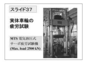
ドイツから車輪を空輸してもらって,車輪タイヤから試験片を取り出して疲労試験をしました。
