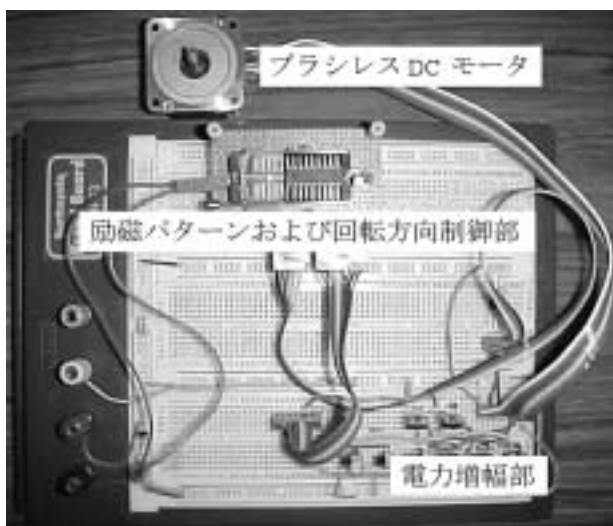
図21 製作したドライブ回路 (ワンチップマイコンを用いた場合)
