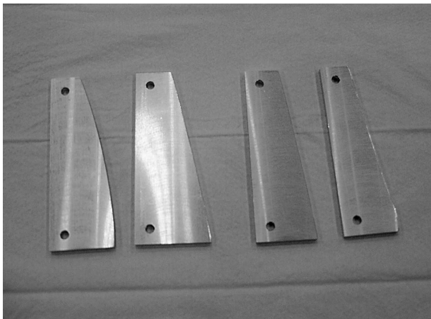
図12 各受講生のカム形状 (各自で決めたパラメータによりカム形状が違う)
