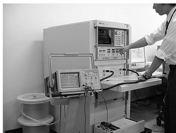
写真3 ネットワークアナライザによる誘電率測定実験
