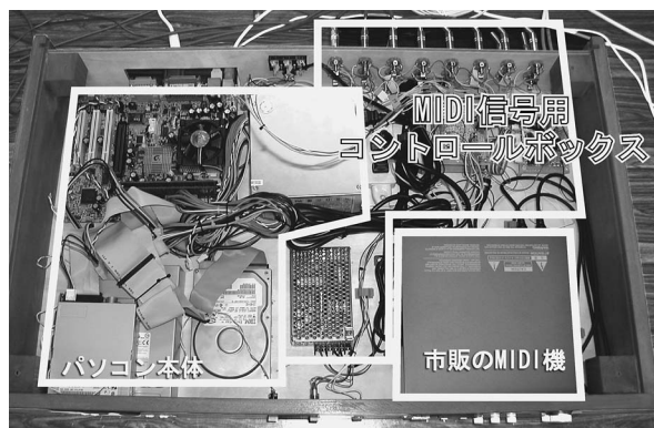
図7 5号機の本体内部
