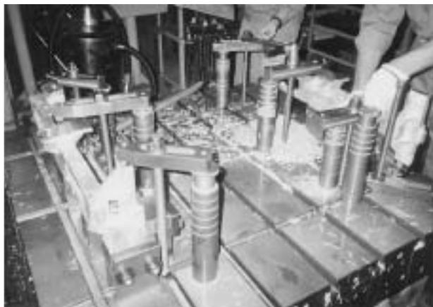
図2 機械加工の段取り作業
