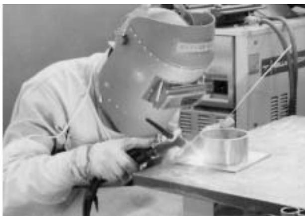
図2 水平管の溶接
