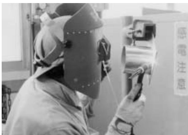
図3 固定管の溶接
