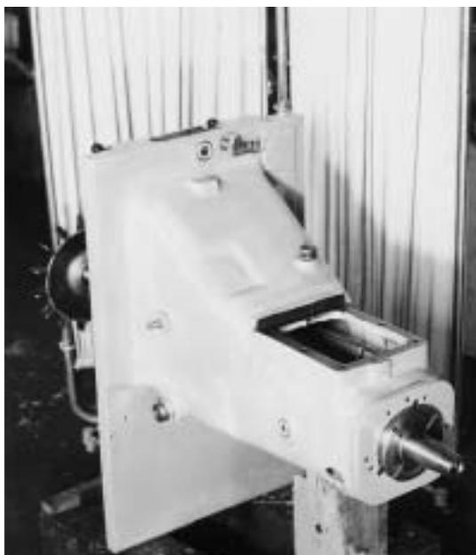
前後のすべり軸受は3個ずつ6個のセグメントメタルで支持している。メタルの締め付け調整は、後部のモーターファンの端を両手で約8～10kgの力を左方向に加えて、回りはじめた後は軽く回転する程度である（正しい給油状態で）。
