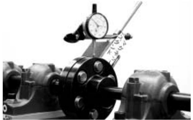
写真15 ダイヤルゲージ使用による調整
