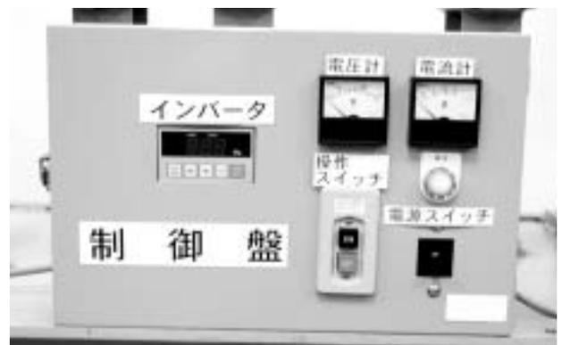
写真4 電流計, インバータ等
