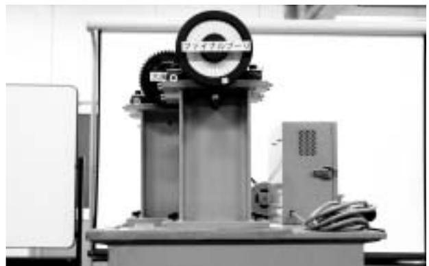
写真9 3軸のVプリー角度目盛板
