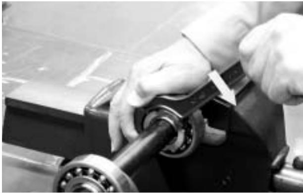
写真13 アダプタナットの締め付け
