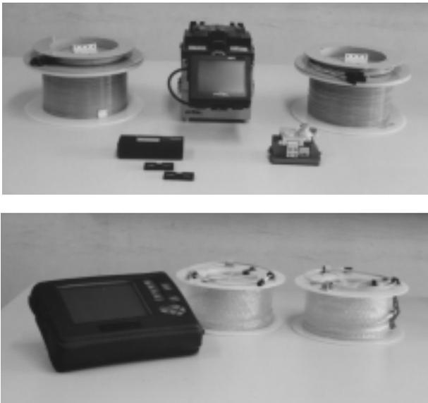
図1 使用機器外観図(融着器およびOTDR)
